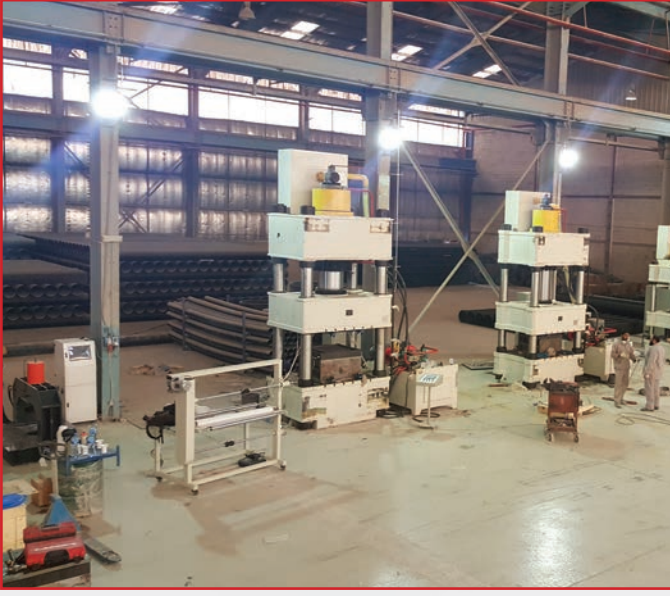
عملية القولبة SMC Molding
