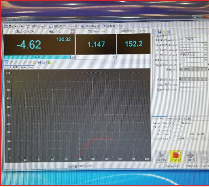
عملية الاختبار بحسب المواصفة القياسية BS EN 124 Polymer matrix frame and cover testing as per BS EN 124
